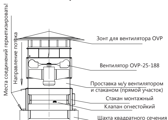
УСТАНОВКА НА МОНТАЖНОМ СТАКАНЕ С ОГНЕСТОЙКИМ КЛАПАНОМ
