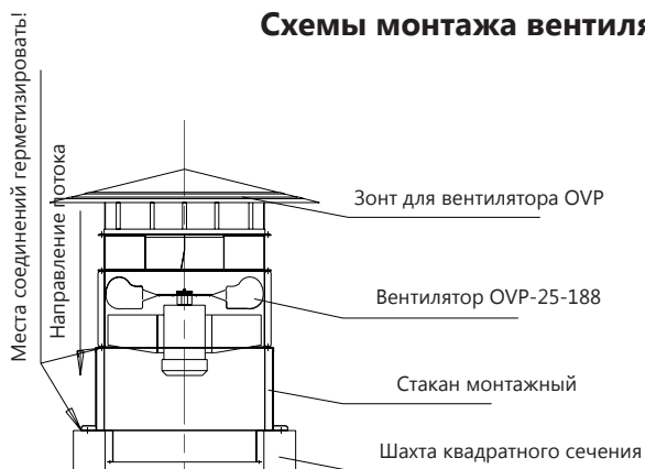
УСТАНОВКА НА МОНТАЖНОМ СТАКАНЕ
